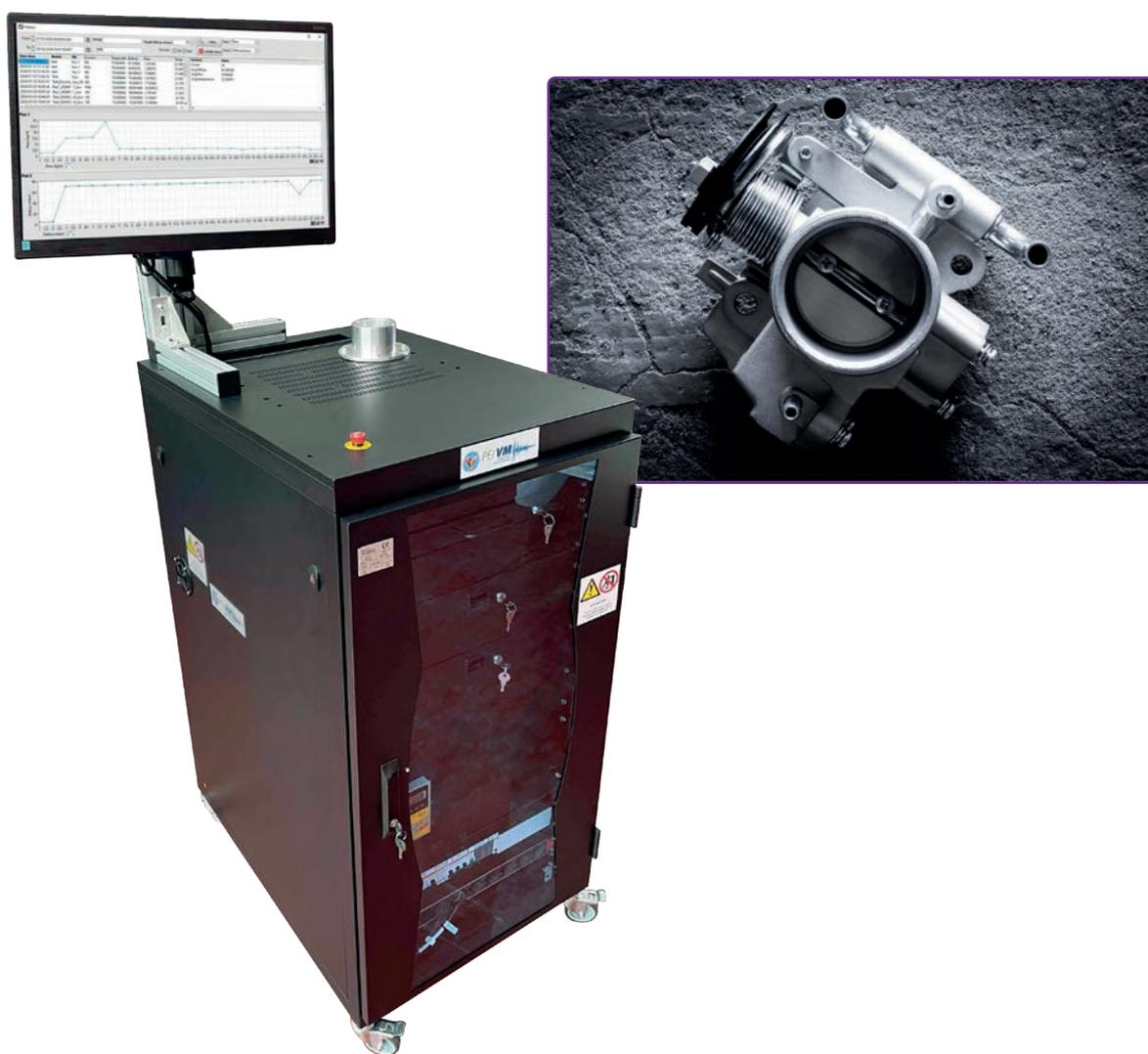
Il software **TTB** regola automaticamente la frequenza di rotazione del compressore interno per raggiungere il target richiesto di portata d'aria che attraversa il corpo farfallato, misurando al contempo la contropressione risultante. Una volta raggiunte le condizioni stazionarie viene effettuata la misura vera e propria, con cui è possibile verificare se le prestazioni sono in linea con i valori di riferimento attesi.
